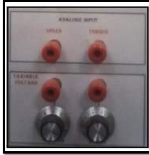
الشكل (6-13): الجهد التشابهي المتغير المتوضع على اللوحة المخبرية
